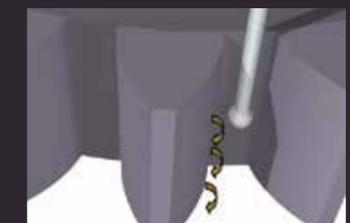
细微齿轮 齿形 / 齿线测量
