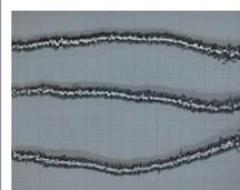
細長捲曲的切屑形狀、切屑順暢排出、可穩定的加工。
